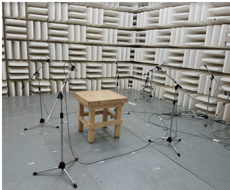
图 9：富士康 CMC 消声室的测试设置具有小于 6 dBA 的背景噪声
