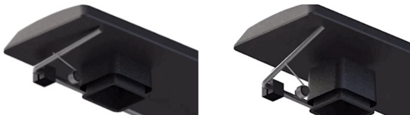
图 4 扭力弹簧结构设计通过将平衡杆和键帽紧密固定在一起降低噪音
